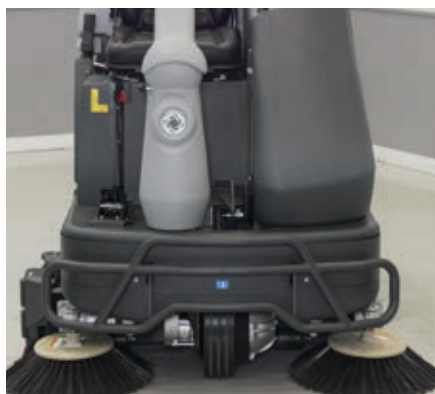
双边刷 (圆筒式型号) 可真正完成边缘清洁
