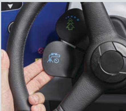
集成到方向盘的间歇式 SmartFlow™ 拨杆： 减少底座上的水流量，防止转弯时溅出，降低 用水量，确保理想的干燥效果。
